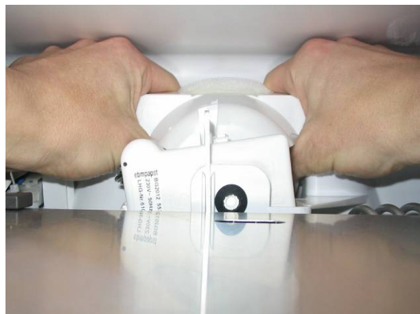
Fig. 5.2.5/ 2 Dismantling fan blade
